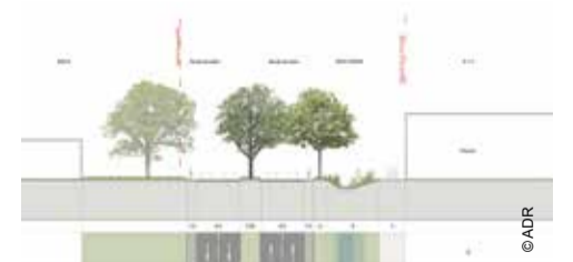
Coupe de principe des aménagements cyclables route de Base
