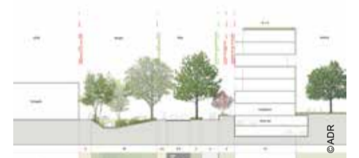
Coupe de principe sur l'aménagement de voies de desserte en zone 30
