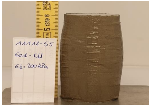
EPR 01 \sigma'_3 = 200 \text{ kPa}
