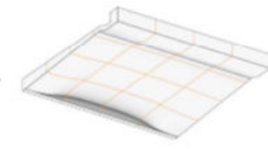
Sous face du voussoir préfabriqué
